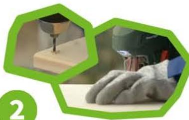
Bauteile mit Stichsäge aussägen, danach Kanten mit Holzfeile glätten und Löcher für Schrauben vorbohren.
