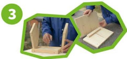
Einzelne Bauteile zusammenschrauben. Dabei mit dem Boden beginnen und hieran die Seitenteile befestigen. Zum Schluss das Dach zusammenbauen.
